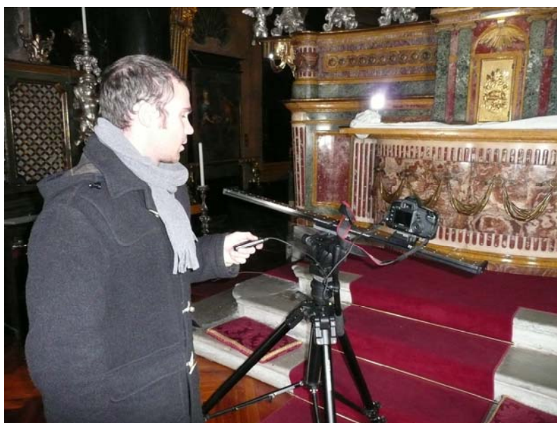
Figura 14– Fotografia relativa al rilievo fotogrammetrico della parte marmorea dell'altare
